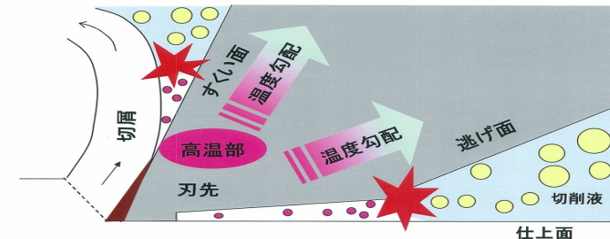
◆図：刃先の仮想潤滑モデル(外部給油)
