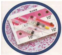
タンク内の腐敗菌濃度を測定。
